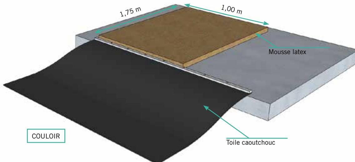
Rabattre ensuite la toile caoutchouc sur les mousses et la tendre (à l'aide de sangles et cliquets). Positionner des profils ABS à l'avant et fixer à l'aide des chevilles à frapper et des rondelles tous les 25 cm.
